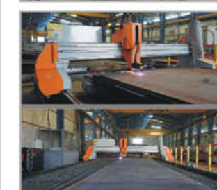
دستگاه برش پلاسما 5 محور با تکنولوژی هایپرترم آمریکا با ابعاد کارگیر 4300 mm × 15000 mm Axis plasma cutting machine with Hypertherm technology of US, working width 4300 mm × 15000 mm
