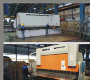
گیوتین برش CNC عرض 6 متر و پرس برک CNC - 300 Ton CNC guillotine cutting machine, width 6 meters and CNC brake press-300Ton
