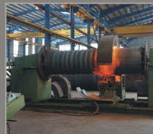
ماشین کاروگیت با طول کارگیر حداکثر 6000 mm و ضخامت کاری تا 25 mm corrugating machine, 6000 mm length and 25 mm working thickness
