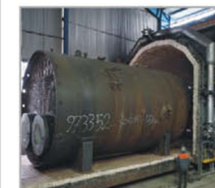
کوره عملیات حرارتی و تنش زدایی °C 1100 با حجم 500 متر مکعب و دقت دمایی °C 5± Post-weld heat treatment furnace 1100 °C with a volume of 500 m³ and temperature accuracy of +/-5 °C
