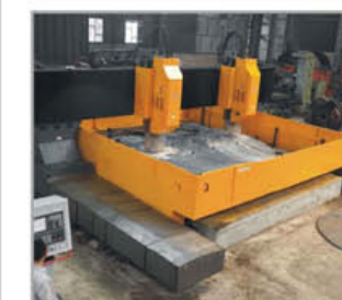
دستگاه دریل فرز CNC با تکنولوژی زیمنس آلمان و کارکرد همزمان دو اسپیندل با ابعاد کارگیر 5000 mm × 5000 mm CNC milling drill, Siemens technology and two spindles working at the same time, working width 5000mm × 5000 mm
