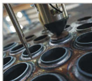
ماشین جوش اوربیتال تمام اتوماتیک از برند Polysoude فرانسه Fully automatic orbital welding machine of French polysoude brand
