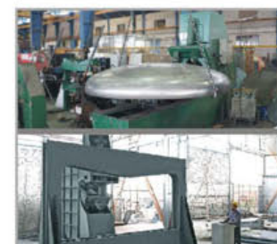
ماشین لبه زن الیپتیکال با قطر کارگیر حداکثر 45 mm و ضخامت حداکثر 45 mm Elliptical Flanging machine with a working diameter of 4000 mm and a working thickness of 45 mm
