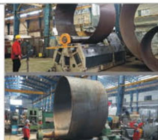
ماشین نورد 4 غلتک هیدرولیک CNC با ابعاد کارگیر 3300 mm و ضخامت کار حداکثر 60 mm Rolling machine with 4 hydraulic rollers, 3300 mm working width and 60 mm working thickness
